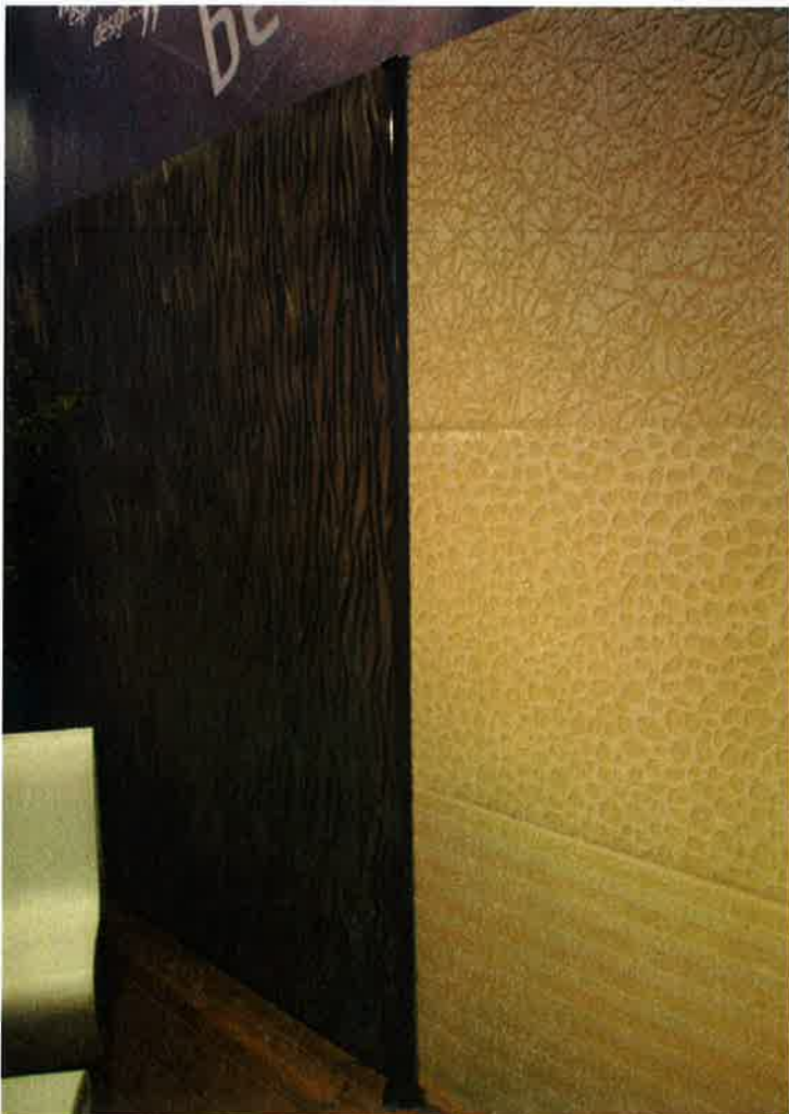
Clôtures Nicolas a montré un panneau qui semble fait en plastique, mais en réalité, il est fait en béton renforcé de fibres.
