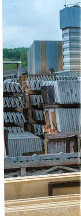
Stock extérieur des plaques, des soubassements et des poteaux pour clôture.
